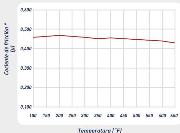
(\*) Basado en 2do. Ensayo Desvanecimiento, Norma SAE J661
